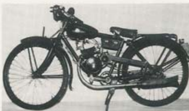
HVA 1939 med HVA 98 cc-motor. Bränsleförbrukning 0,22 lit/mil. JJ.
