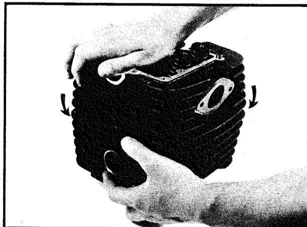
Montera pinnbultarna igen. Byt o-ringen kring kamkedjetunneln och montera topplocket. Se till att ståltrådarna som håller kamkedjan kommer upp igenom topplocket.
