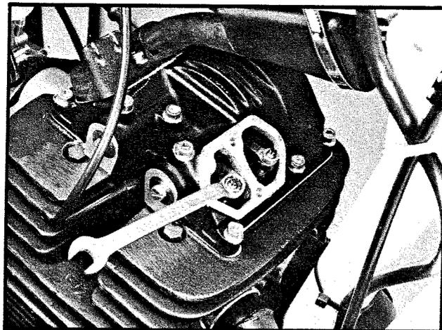
Använd en liten skruvmejsel och skruva justerskruven så att inget spel kan kännas mellan vipparmen och ventilen.
