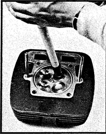
Använd ventilsnurra **1519795-01** och ventilslippasta (carburundum fin) för att slipa in ventilen. Tvätta bort all slippasta och kontrollera att ventilen är tät genom att fylla T-sprit eller liknande i förbränningsrummet och se till att det inte rinner ner i kanalerna. Håll topplocket upp och ner och använd ficklampa eller dylikt.
