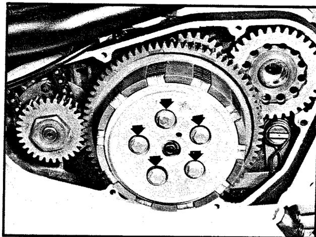
Tag bort tryckstången. Tag bort låsringen för köplingscentrumet och lossa centrumet. Detta göres bäst genom att skruva 3 skruvar, med lång gänga, genom köplingscentrumet så att skruvarna trycker på köplingskorgen och därigenom trycker upp köplingscentrumet.
