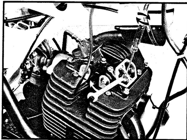
Vrid skruven tillbaka 2/16 varv (insug) eller 3/16 varv avgas. Ventilspel 0.10 mm insug och 0.15 mm avgas. Drag åt låsmuttern utan att skruven rör sig. Moment för låsmuttern 12 Nm.
