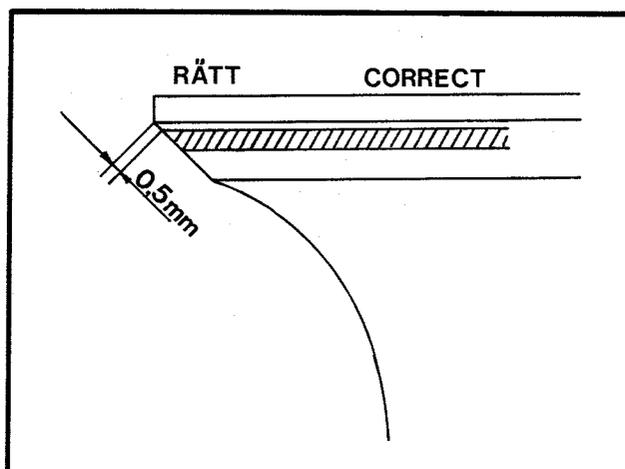
Om anliggningsytan ligger för lågt, fräs om sätet med 70° och 45° fräsen. Se till att bredden på anliggningsytan blir rätt.
