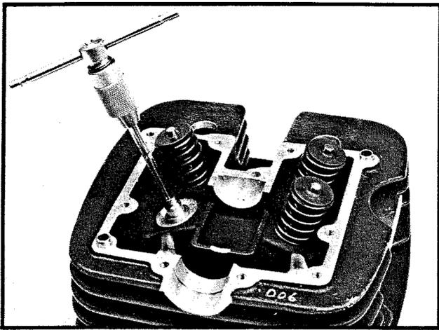
Använd Brotsch **1517901-01** och skärolja när styrningen brotschas. Vrid brotschen när den dras ur styrningen så att inga längsgående repor bildas. OBS! När en styrning byts måste ventilsåtet fräs om.
