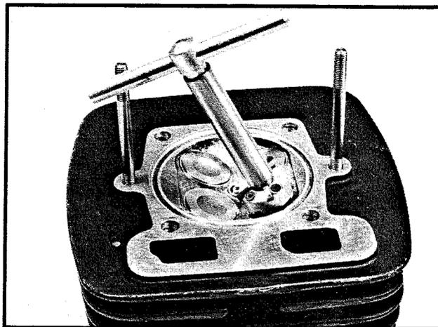
Använd 15° fräsen och 70° fräsen för att få rätt bredd på anliggningsytan (45°).
