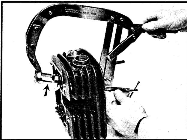
Använd ventilbåge och distans när ventilknasterna monteras.
