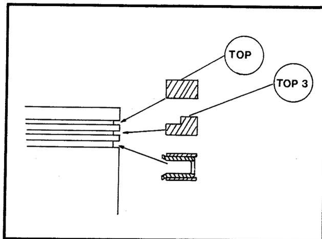
Tag bort de två översta kolringarna från kolven och kontrollera kolringsgapet. Om det är mer än 0.60 mm skall kolringen bytas.
