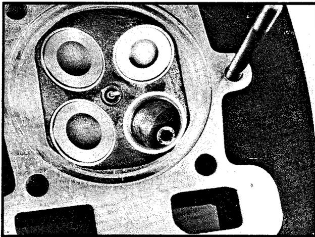
Kontrollera ventilsåtet, om det finns några låga fläckar eller andra skador måste sätet fräsas om.
