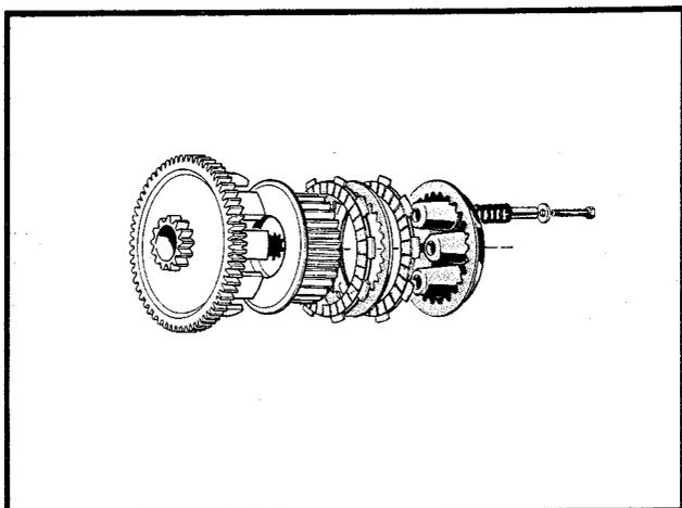
OBS! Det skall vara 8 lameller med belägg och 7 lameller utan belägg.
