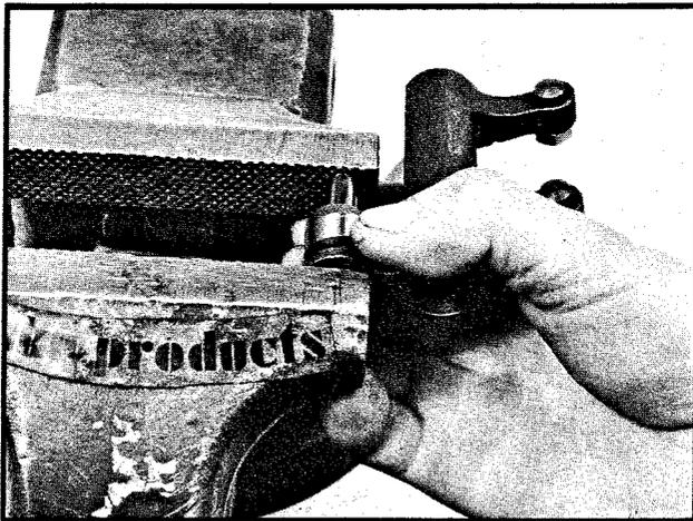
Håll rullen på plats i vipparmen och pressa in rullyftaraxeln. Använd ett skruvstycke. Var försiktig så att vipparmen inte skadas. Lås rullyftaraxeln med ett körnslag från varje håll.
