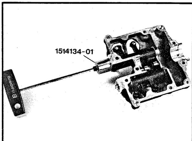
Skruva ur de två skruvarna ur ändarna på ändpluggarna.
