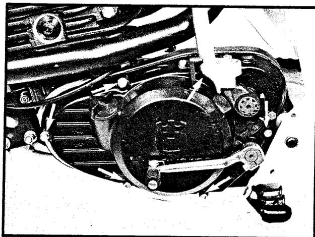
Lossa de 5 skruvarna som håller köplingsfjädrarna. Tag bort tryckplattan, köplingsfjädrar, distanshylsorna och alla lameller.
