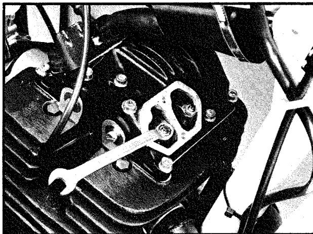
Använd en liten skruvmejsel och skruva justerskruven så att inget spel kan känna mellan vipparmen och ventilen.
