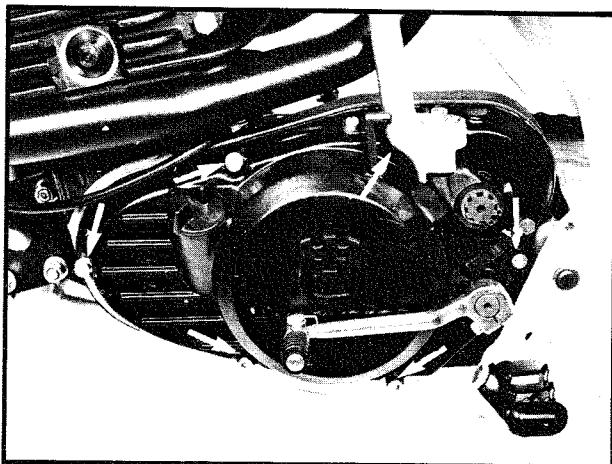
Lossa de 5 skruvarna som håller kopplingsfjädrarna. Tag bort tryckplattan, kopplingsfjädrar, distanshylsorna och alla lameller.
