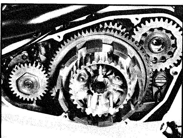
Tag bort kopplingskorgen. Kontrollera så att den inte är sprucken eller skadad.
