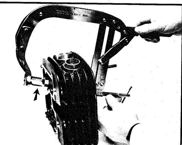
Använd ventilbåge och distans när ventilknasterna monteras.
