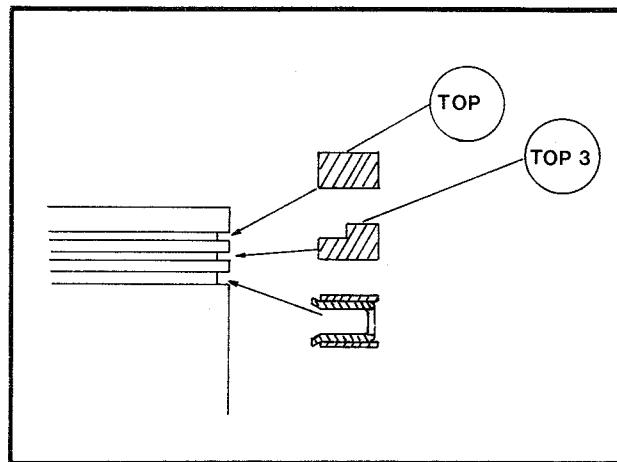
Tag bort de två översta kolvringarna från kolven och kontrollera kolvringsgapet. Om det är mer än 0.60 mm skall kolvringen bytas.
