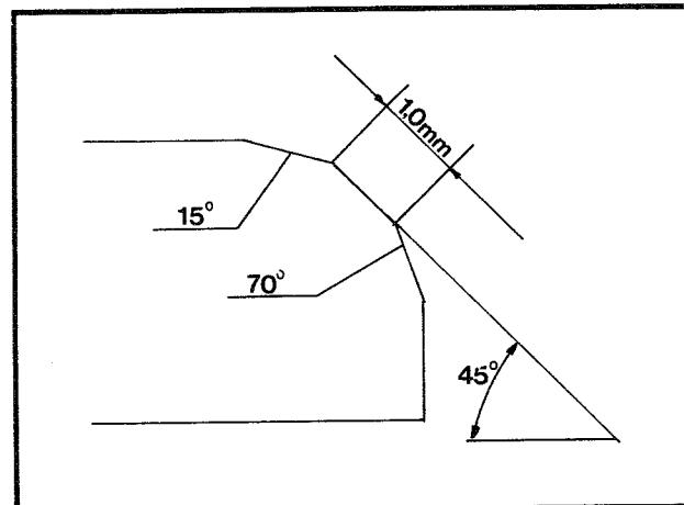
Det är viktigt att anliggningsytan på ventilen ligger på rätt ställe. Använd märkfärg för att se hur anliggningsytan ligger. Anliggningsytan skall ligga 0.5 mm från kanten på ventilen.
