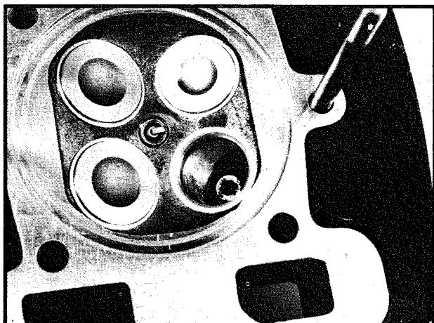
Kontrollera ventilsätet, om det finns några låga fläckar eller andra skador måste sätet fräsas om.
