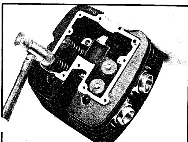
Knacka försiktigt med en plasthammare på ventilerna så att ventilknasterna sätter sig på plats.
